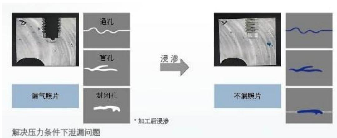
对产生泄漏的工件实施真空加压浸渗处理
